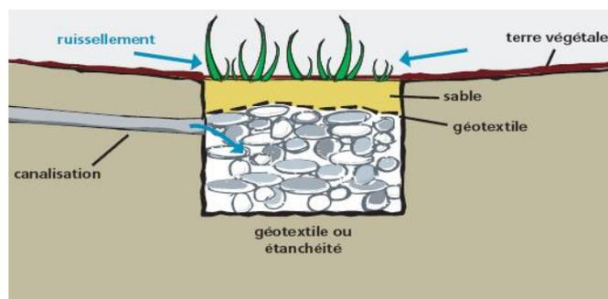
Le stockage de l'eau s'effectue dans les structures granulaires reconstitué (galets, roches concassées, graviers, matériaux alvéolaires). l'eau est ensuite infiltrée ou reconstituée à débit régulé dans un cours d'eau ou un réseau.
